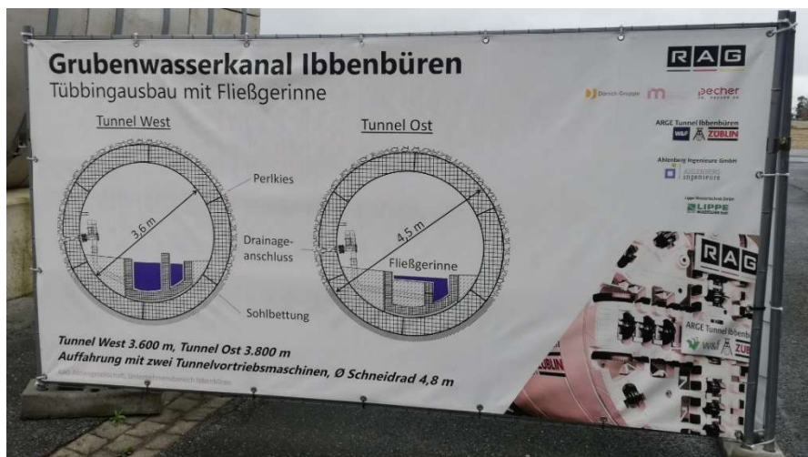
Technischer Aufbau des Grubenwasserkanals (Quelle: Friedel Wielers)
