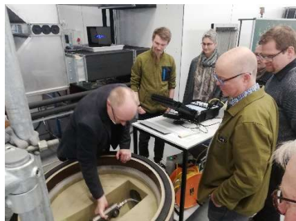
Kamerabefahrung eines Kanalstrangs (Quelle: Friedel Wielers)
